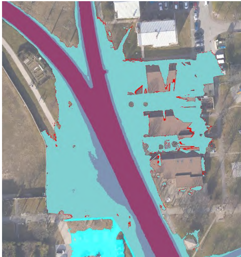
Slika 24: Primerjava globin vode med obstoječim in predvidenim stanjem z izvedbo nasipa na desnem bregu ter rekonstrukcijo mostu na Goriški cesti (rdeče označena območja s povišanjem gladin in poslabšanjem dosegov v območju vrtca na levem bregu zaradi izvedbe nasipa)
