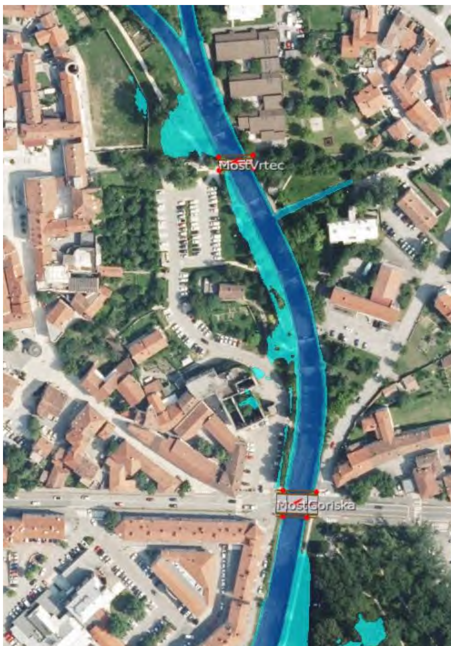
Slika 16: Prikaz rezultatov hidravličnega modela za obstoječe stanje pri pojavu stoletnih voda
