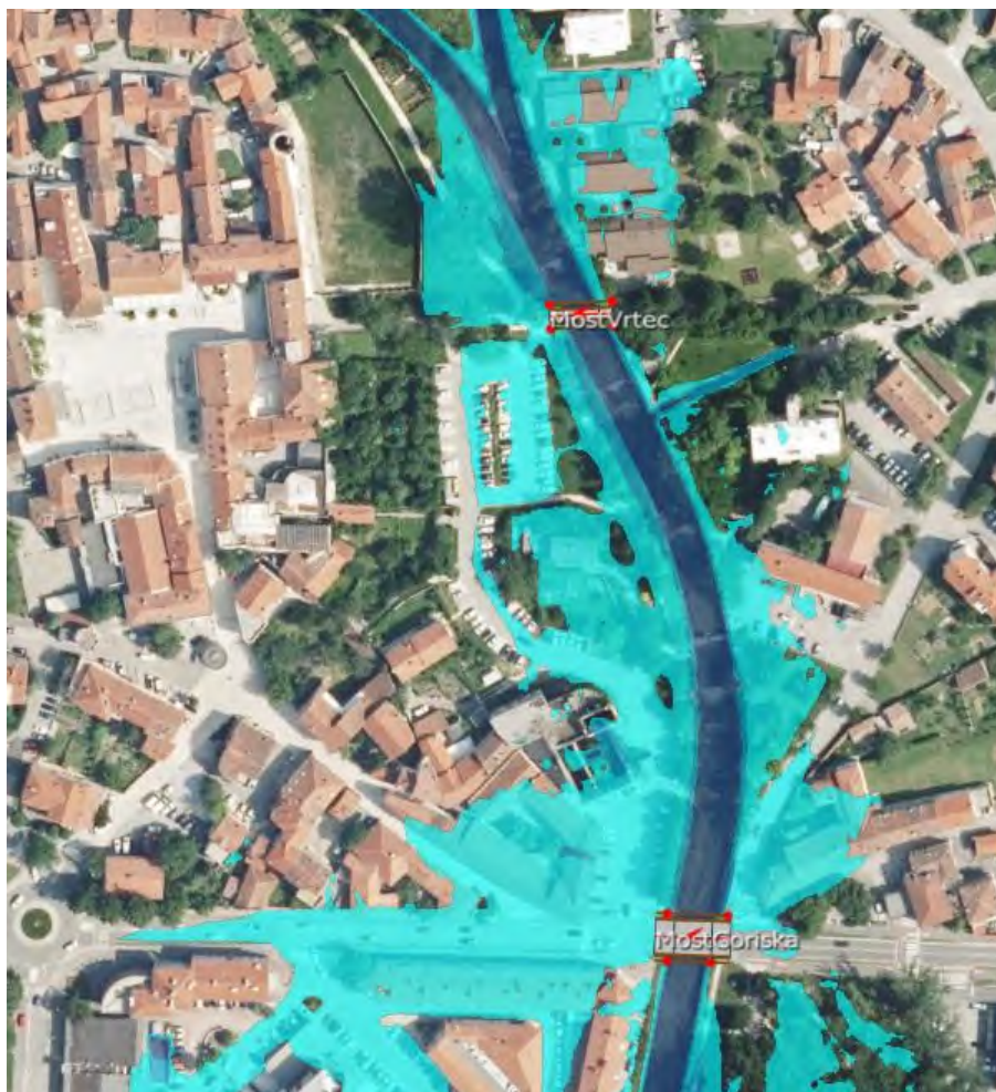
Slika 17: Prikaz rezultatov hidravličnega modela za obstoječe stanje pri pojavu petstoletnih voda
