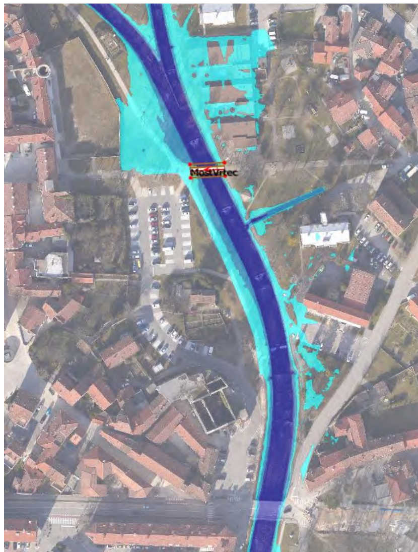
Slika 23: Doseg petstoletnih voda v primeru izvedbe protipoplavnega nasipa na desnem bregu v območju OPPN ter rekonstrukciji cestnega mosta na Goriški cesti
