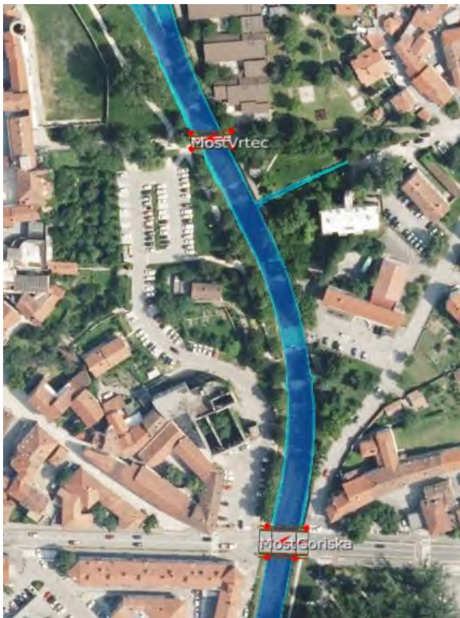
Slika 15: Prikaz rezultatov hidravličnega modela za obstoječe stanje pri pojavu desetletnih voda
